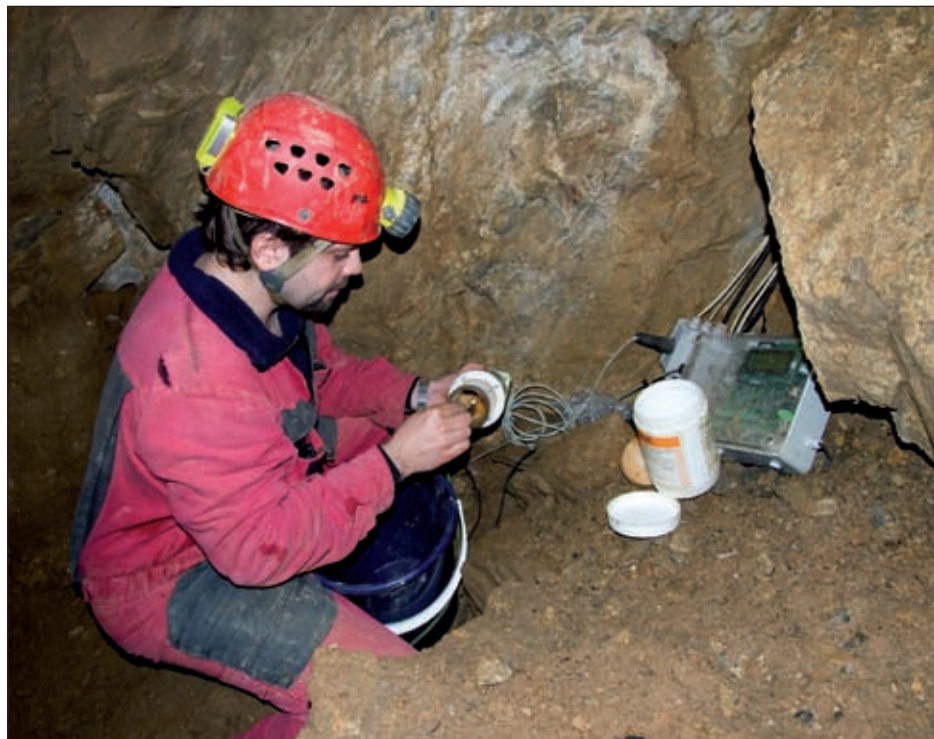
Slávek Černý vyměňuje sušidlo u čidla \text{CO}_2 v Puklině v Gallašově dómu. Foto: Pavel Sencovič
