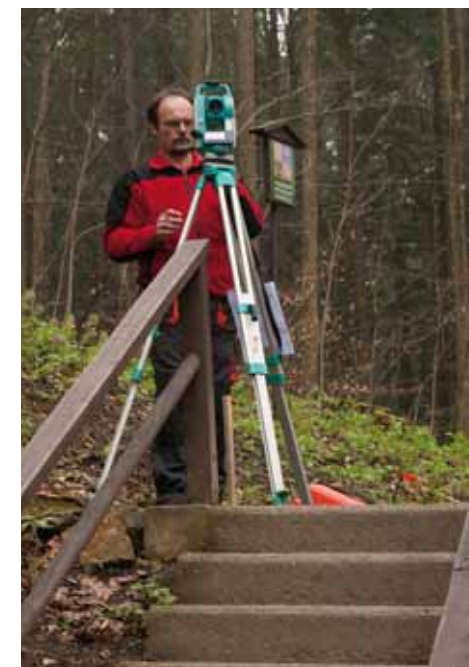
Hlavní důlní měřič zodpovídá při kontrolách báňské správy za veškerou mapovou dokumentaci zpřístupněných jeskyní. Vratík Ouhrabka zaměřuje aktuální situaci na povrchu po vybudování nového chodníku od východu z Jeskyní Na Pomezí.
