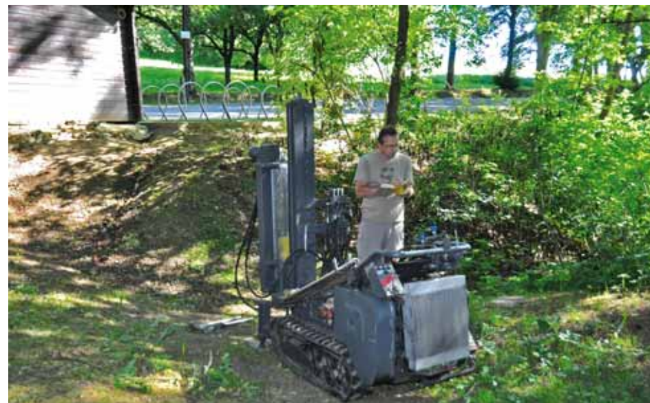
Penetrační sonda v místě stavby Výtopny. Foto: František Krejča, SJ ČR
