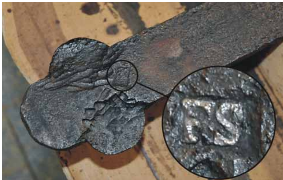
Kované zakončení ramene s detailem identifikační značky. Písmena jsou pro názornost graficky zvýrazněna. Foto: František Krejča, SJ ČR
