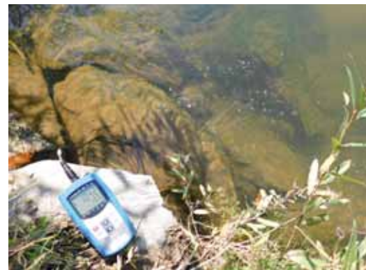
Měření konduktivity a teploty vody ve výrazném vývěru kyselky nazývaném Pod smrkem. Foto: Hana Koryčánková
