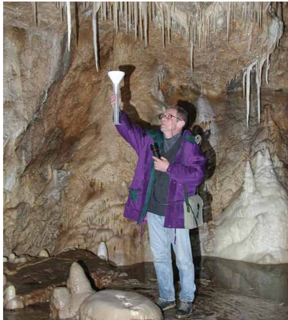
Medvědi jeskyně, Jacek Piasecki měří množství skapu za daný časový úsek. Foto: Jiří Hebelka, SJ ČR
