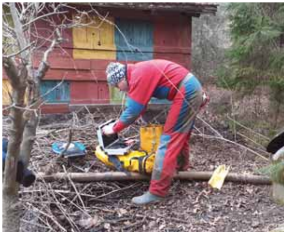
Autor článku při stahování dat z čidla ve vrtu HJ-2 zvaného U včelína poblíž lomu Černotín. Foto: Barbora Šimečková, SJ ČR
