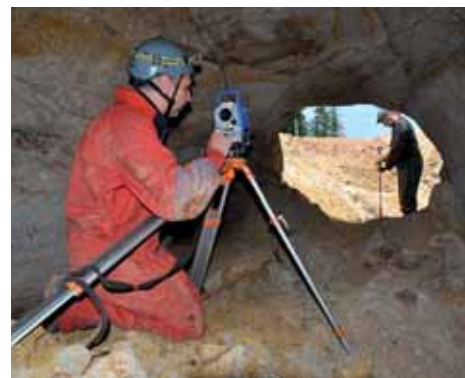
Průzkum a dokumentace projevu starého důlního díla v linii dálnice D3 u Českých Budějovic.
