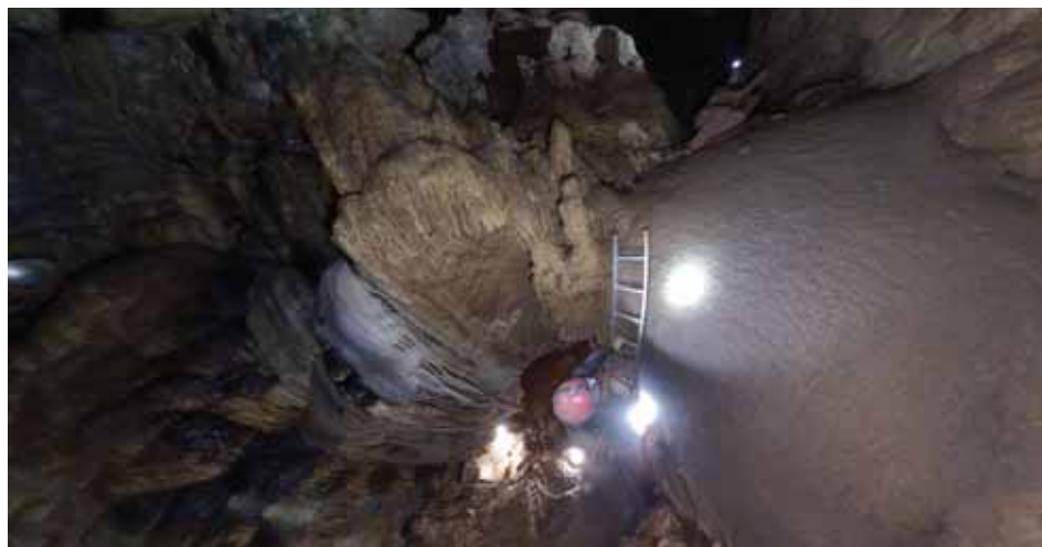
Skenování jeskyně metodou „SV“. Světlo v ruce speleologa je kruhové osvětlení z „digitální louče“ pod sférickou kamerou. Foto: Jiří Šindelář
